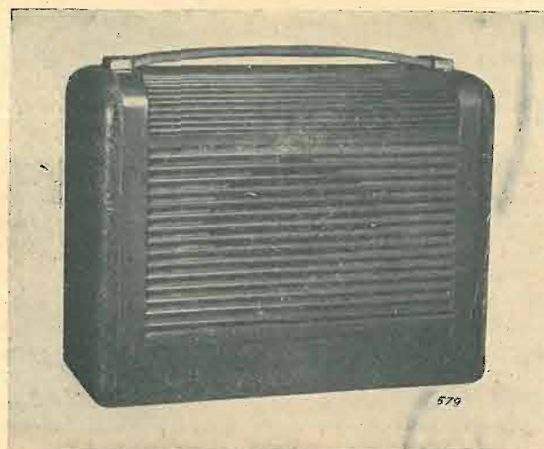
Fig. 2 - Ricevitore americano a sette valvole per onde medie e corte e modulazione di frequenza (Mod. PHILCO 442).
